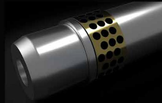
Bronze-Graphit-Buchsen, die in Ausleger-Arm- und Ausleger-Rahmen-Verbindungsstellen zum Einsatz kommen, verlängern das Schmierintervall und verhindern in hohem Maße den Verschleiß der Bolzen, da Graphit, das eine sehr hohe Fettaufnahme- und Rückhaltefähigkeit hat, in die innere Struktur der Buchsen eingebettet ist.
